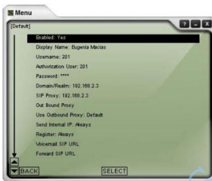
Figura No. 11. Configurando parámetros SIP
