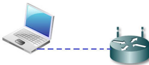
Figura No. 3. Conexión punto a punto
