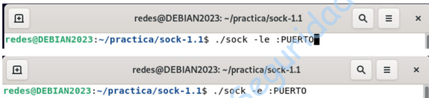
Figura No. 13. Creación de un socket servidor y de un socket cliente
