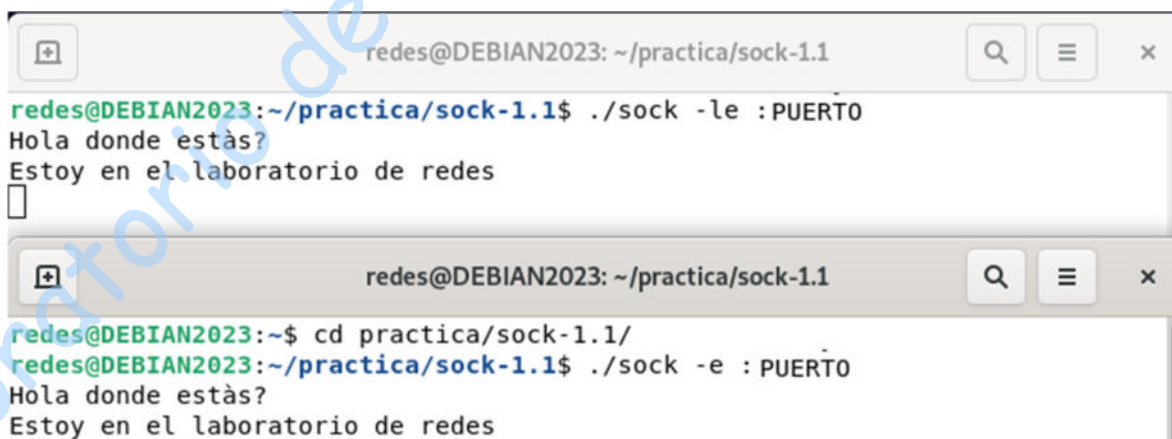
Figura No. 14. Comunicación entre terminales
